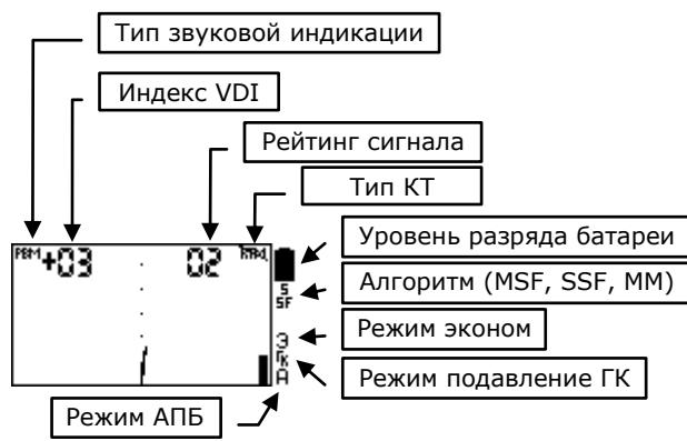
Индекс VDI – английская аббревиатура “Visual Discrimination Indication” (“индикация визуальной дискриминации”). Это так называемый индекс электропроводности объекта. Угол между вертикальной осью и преимущественным направлением гидографа. При этом гидографы находящиеся в левой части экрана имеют
