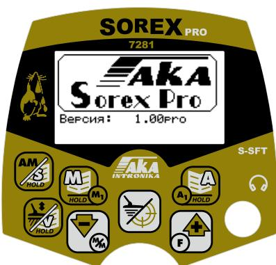
На передней панели прибора расположен жидкокристаллический графический дисплей, выход на наушники и 7 кнопок управления детектором (см. рис.). На обратной стороне системного блока прибора находятся разъем для подключения поискового датчика (катушки), клавиша включения/выключения прибора и отсек для элементов питания прибора.
